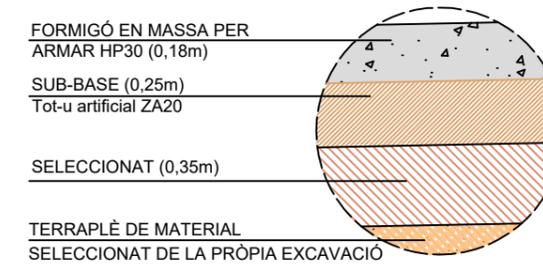
SECCIONS TIPUS EN LATERALS DE CAMINS DE 5 MTS I EN CAMINS EXISTENTS ( TRANSIT NO PESAT )
